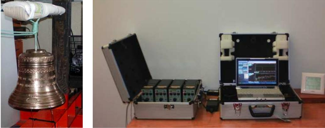
Figura 5.2: *Setup* experimental utilizado para os ensaios em laboratório. Esquerda: sino laboratorial pendurado. Direita: amplificadores de carga e sistema de aquisição.
