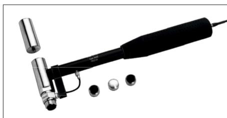
Figura 6.2: Martelo de impacto Brüel&Kjær 8202, vários tipos de cabeças e massa extra utilizados nos ensaios.
