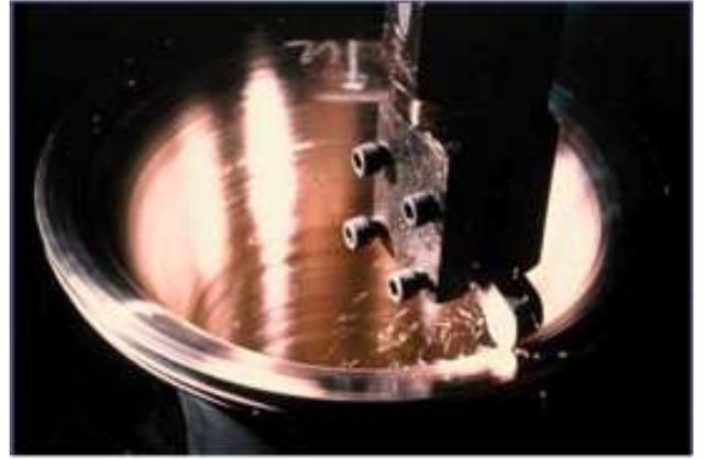
Figura 3.17: À esquerda, um torno vertical de afinação do séc. XIX. À direita, afinação de um sino num torno moderno. Gravura e fotografia de Whitechapel Bell Foundry, Ltd. Recuperado de <http://cccbr.org.uk/pr/publicity/bellsandbellringing/>). Copyright [1999-2012] por Central Council of Church Bell Ringers. Reimpresso com permissão.
