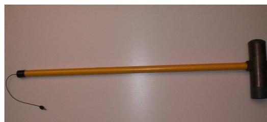
Figura 6.3: Martelo de impacto desenvolvido em laboratório com o intuito de excitar a gama de frequências de interesse dos sinos de maiores dimensões.
