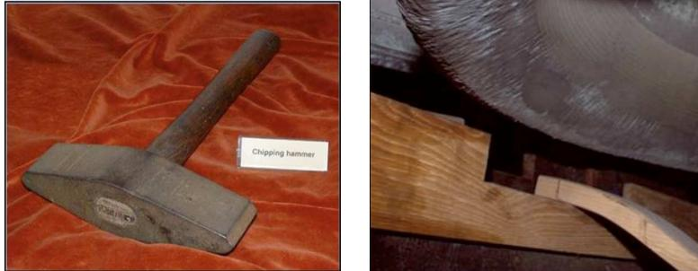
Figura 3.13: Martelo de lascagem, à esquerda e, ao lado, sino onde foi utilizada esta técnica (Reimpresso de The Central Council of church bell ringers. Fotografias de R.Offen e Andrews. Recuperado de [http : //ccbr.org.uk/pr/publicity/bellsandbellringing/](http://ccbr.org.uk/pr/publicity/bellsandbellringing/)). Copyright [1999-2012] por Central Council of Church Bell Ringers. Reimpresso com permissão.
