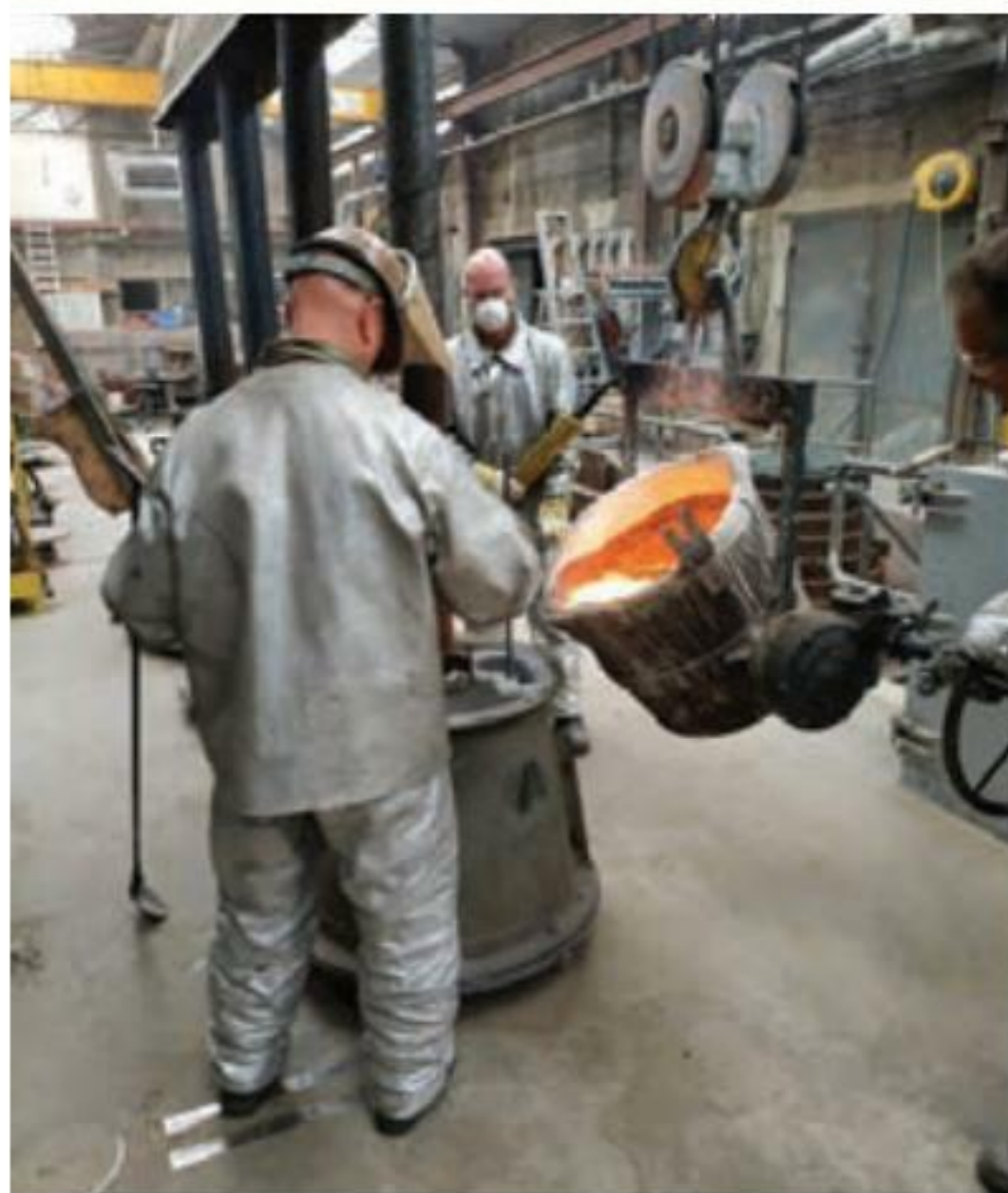
Figs. 35 e 36 Fundição do sino n.º 31, instalações da Royal Eijsbouts em Asten, Países Baixos © AOF
