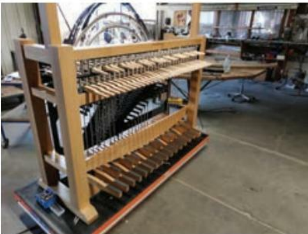
Fig. 32 Construção de um novo teclado pela Royal Eijsbouts, Asten, Países Baixos © AOF
